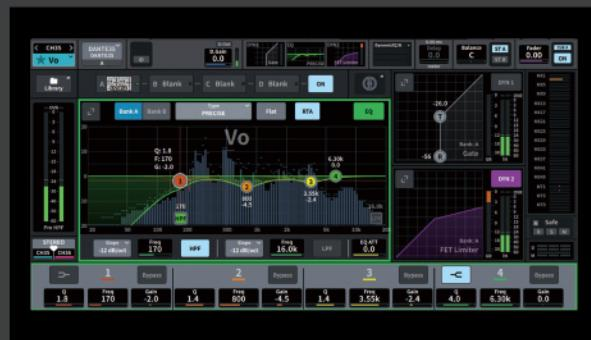
고급스러운 그래픽을 지원하는 DM7 시리즈의 사용자 인터페이스는 오디오 엔지니어의 즐거움으로, 사용자가 콘솔 기능의 깊이있는 활용을 위해, 즉시 직관적으로 액세스할 수 있는 궁극의 터치 조작 편의성을 제공합니다. 채널 스트립의 작동 정보 목록을 제공하는 Selected Channel View는 이전 GUI의 최상의 기능을 유지하지만 이전보다 더 줄어든 단계와 시간으로 작동방식이 업데이트 되었습니다. 이제 일상생활에서 사용하는 것과 동일한 느낌의 익숙한 터치 스크린 조작으로 믹싱 콘솔을 컨트롤 할 수 있습니다.
