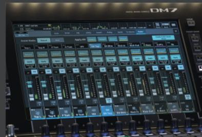
추가된 DM7 시리즈 "Assist"는 중요하지만 반복적인 작업을 처리하는데 효율적인 새로운 기능으로, 운영자의 창의적인 워크플로우를 도와줄 수 있습니다. Assist는 모든 오디오 엔지니어링 필수 요소인 HA 조정, 채널 네이밍 및 균형 잡힌 페이더 레벨을 "제안"하여 엔지니어가 보다 창의적인 작업 및 커뮤니케이션에 집중할 수 있도록 지원함으로써 설정 및 준비 시간을 단축하는 기능입니다. HA Assist는 입력 신호 레벨에 따라 적합한 HA 레벨을 제안하고, Naming Assist는 입력 신호 정보를 사용하여 각 채널에 대한 아이콘/채널 이름을 제안하며, Fader Assist는 할당된 채널에 대한 페이더 밸런스를 제안합니다. 이러한 제안은 사용자의 피드백과 권장 사항을 기반으로 계속 발전할 것입니다.
