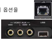
뒷면 패널의 LAN 단자(위) 및 전면 패널 비디오 Aux 단자와 USB 포트(아래)
