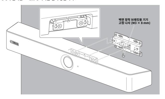
3. 벽면 장착 브래킷 아래에서 포함된 기기 고정 나사 (M3  $\times$  8 mm) 를 사용하여 기기를 벽면 장착 브래킷에 고정합니다 .
