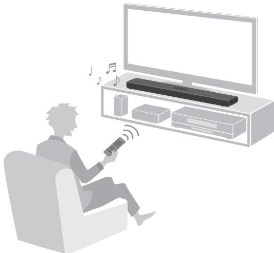
HDMI 케이블을 통해 TV의 Audio Return Channel(“eARC” 또는 “ARC”로 표시됨)과 호환되는 HDMI 입력 단자에 사운드 바를 연결하면 TV에서 사운드 바로 제어 신호가 전송됩니다. 이렇게 하면 TV 리모컨으로 사운드 바를 제어하는 HDMI 제어 기능을 사용할 수 있습니다. 또한 HDMI 케이블을 통해 TV 오디오 신호가 사운드 바에 전송됩니다. 따라서 하나의 HDMI 케이블을 사용하여 사운드 바를 TV에 연결할 수 있습니다.
