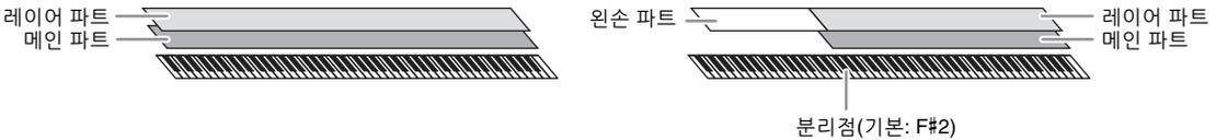
왼손 파트를 켜면 전체 건반이 메인 및 레이어 파트에 사용됩니다. 왼손 파트를 켜면 F#2와 낮은 건반은 왼손 파트에 사용되고 높은 건반(F#2 제외)은 메인 및 레이어 파트에 사용됩니다. 건반을 왼손과 오른손 부분으로 나누는 건반을 “분리점”이라고 합니다.
