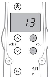
\* "od"(overdrive) 설정은 최대 음량으로, 가장 큰 소리를 납니다. 특정 음과 낮은 범위에서는 소리가 왜곡될 수 있습니다.
