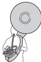
1. 벨 나사를 풁니다. 벨 양쪽을 단단히 잡고 본체의 벨 조인트 안으로 벨을 집어 넣는 동시에 천천히 돌립니다. 벨을 올바로 위치시킨 다음 3개의 벨 나사가 모두 같은 힘으로 벨을 누르도록 벨 나사를 조입니다.
