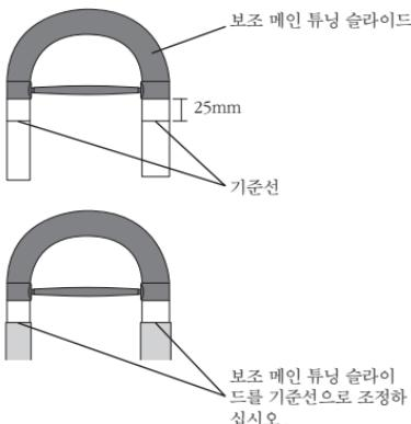
본 악기는 일반 피치(보조 메인 투닝 슬라이드를 위의 홈 위치로 조정)가 기존 투바(메인 슬라이드를 악기 끝에 삽입)와 거의 동일하도록 제작되었습니다. 다음과 같은 조건으로 인해 피치가 낮은 경우 보조 메인 투닝 슬라이드를 더욱 안쪽으로 움직여 피치를 높게 조정합니다.
