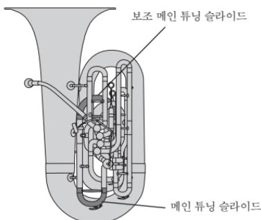
YCB-623 및 YBB-623에는 모두 보조 메인 투닝 슬라이드가 장착되어 있습니다. 일반적으로 메인 투닝 슬라이드를 안팎으로 조정하여 악기를 투닝합니다. 보조 메인 투닝 슬라이드는 보조 악기 투닝을 위한 보조 메커니즘으로 사용됩니다.
