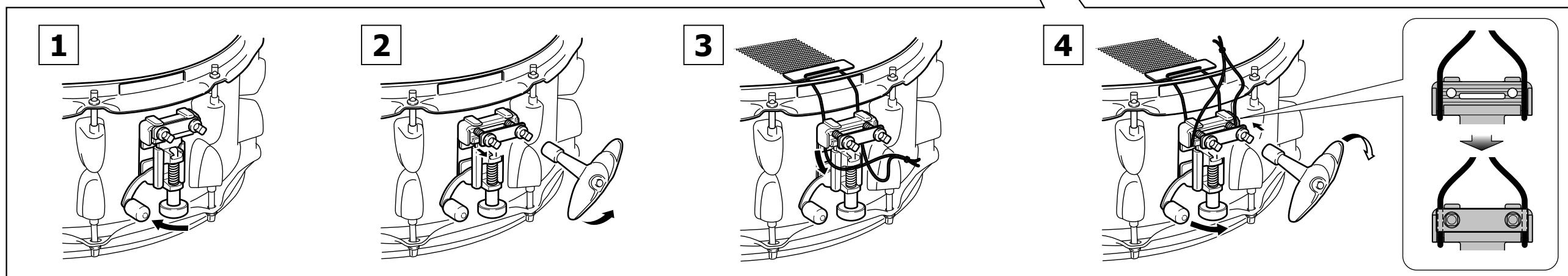
■ストレイナー Pへのスネアテープ取付方法 ■How to attach the snare tape to the P strainer
